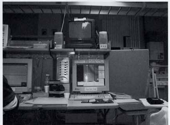
図4：Suprime-Camの制御機。写真中央にあるワークステーションで様々なコントロールを行うほか、上のモニター、スピーカーでSuprime-Camの状態を監視している。
