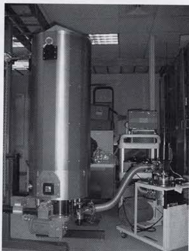
図2: 山麓の実験室でCISCOを真空に引いているところ。左の筒がCISCO。
