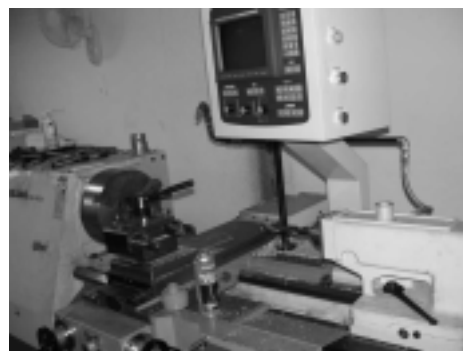
写真は某公開天文台の工作室の中にあるNCフライス盤という、コンピュータ制御で金属を思い通りに削る機械です。
