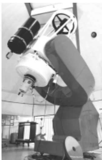
図10：西はりま天文台の60センチ望遠鏡（左）は赤道儀式、今度の2メートル望遠鏡（右）は経緯台式の架台を採用している
