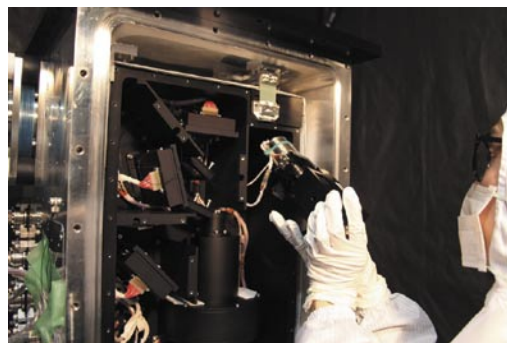
写真3 開腹したNICから「直動ユニット」を取り出す。この中にある偏光シフタの向きを変える
