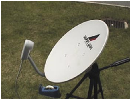
BS 放送用のアンテナで太陽電波を受信できる
