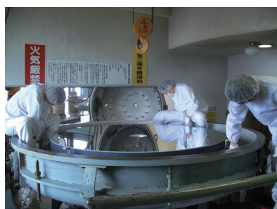
再蒸着された岡山天体物理観測所188cm望遠鏡の主鏡
