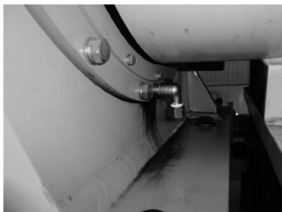
図 1:EL 駆動部からの油漏れ
