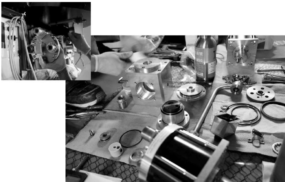
上図: 住重による保守作業。左上は NIC 本体からコールドヘッド部を取り外すところ。右下が部品単位に分解し、清掃および消耗品の交換作業をしているところ。
