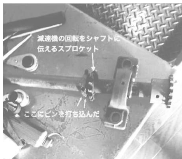
図 2.1.2：開放機構の壊れた物
