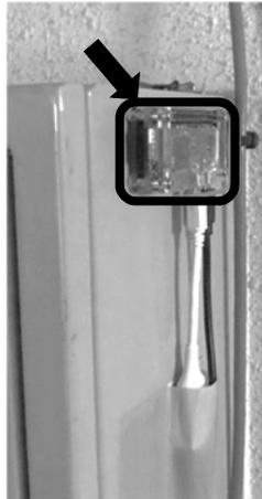
図 10：スリット緊急停止（S2A, S2B）
