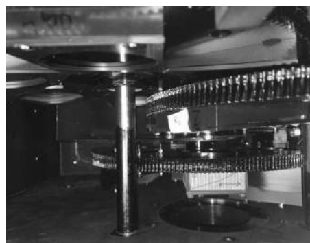
図5 グリズムホイールに設置された ウォラストンプリズム
