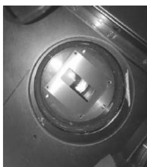
図 4 焦点面に設置された アパーチャマスク
