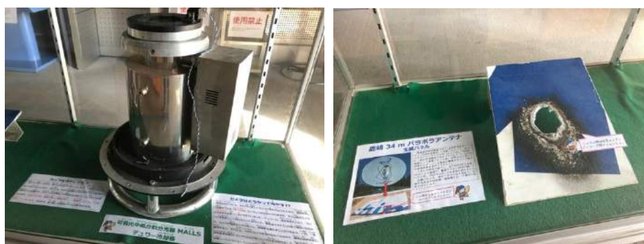
図 2. (左) MALLS 用デュワー冷却器。カメラを冷やす理由や、カメラの冷やし方について簡単な説明を示している (右) 鹿嶋 34 m パラボラアンテナ主鏡パネル。中央付近の穴は、解体の際にバーナーで開けられた。
