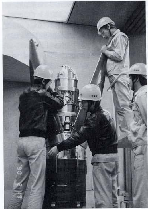
【写真】左：打ち上げリハーサル中の観測ロケット。右：ロケット頭胴部に搭載された赤外線観測装置にノーズコーンをかぶせているところ。上空に上がってから、このノーズコーンが開き、観測が始まる。
