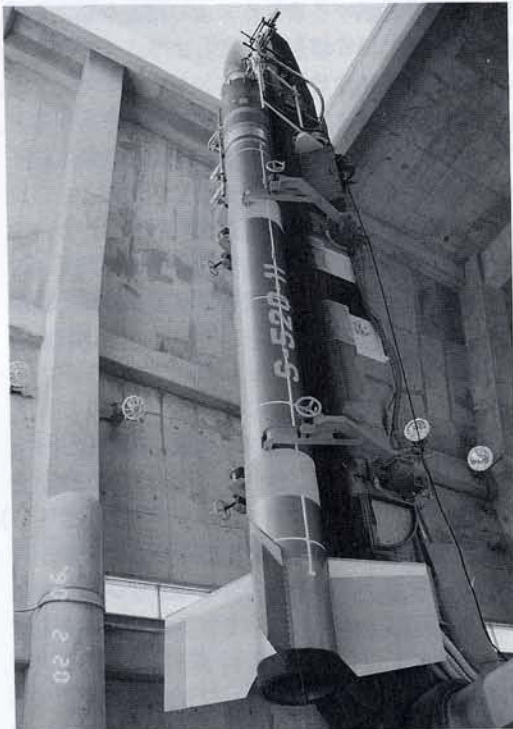
【写真】左：打ち上げリハーサル中の観測ロケット。右：ロケット頭胴部に搭載された赤外線観測装置にノーズコーンをかぶせているところ。上空に上がってから、このノーズコーンが開き、観測が始まる。
