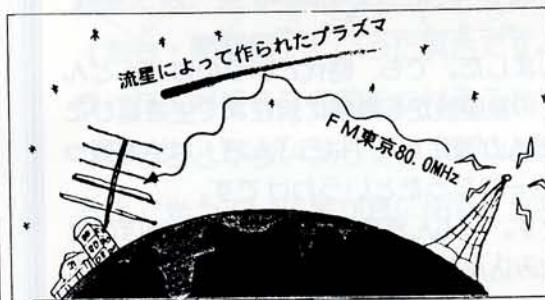
FM放送の電波を用いた、簡便な流星観測がアマチュア天文家の間で広く行われている。FM放送受信用に市販されている3~5素子のハムアンテナを天頂方向に向けて設置する。関西なら、80.0MHzに合わせてFM東京の電波をねらう。地球は丸い。東京で水平方向に発射された電波は、関西地方のはるか上空を通過するので、ふつう関西ではFM東京の電波を受信することはできない。しかし、流星によってつくられたプラズマによって電波がアンテナの方向に反射される一瞬の間だけ、FM東京の電波が受信できる。このことを利用して流星を検出しようというわけである。
