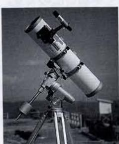
レンズの代わりに、筒の底にある鏡で光を反射させて集めるタイプです。反射望遠鏡には様々なタイプがありますが、代表的なものを紹介します。
