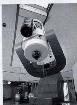
いちばん筒先に補正盤というレンズがあり、効率よく光が取り入れられるようになっています。筒が口径（直径）のわりに短く、コンパクトになっています。惑星を見るのに適しています。
