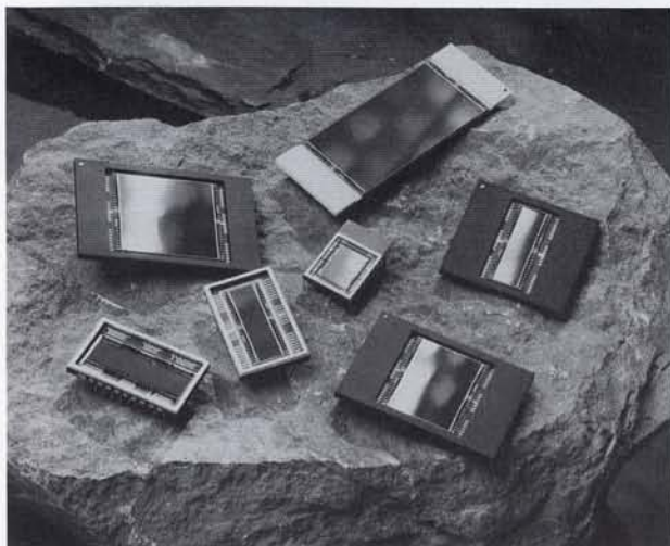
図1：石の上にもCCD（上）。CCDチップの拡大写真（右）。右上の小さな区画の1個1個が電氣的な井戸を形成している。
