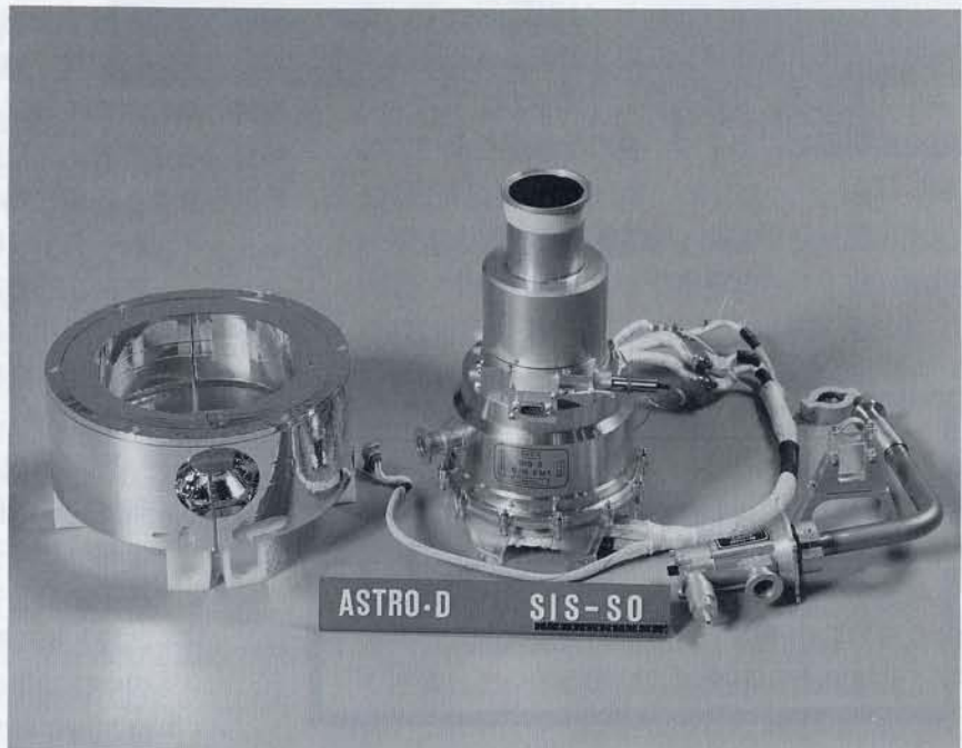
図5:「あすか」に搭載されたX線CCDカメラ
