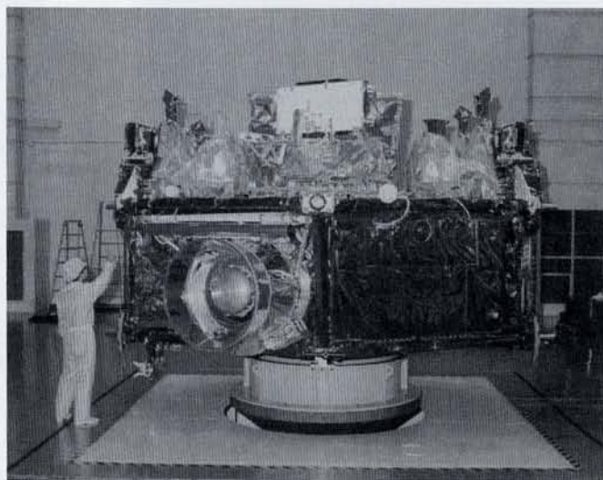
図1. 打ち上げ前のSFU衛星に搭載されたIRTS(中央左)。銀色の円形の部分は宇宙に出るまで望遠鏡内部の真空を保つためのふたである。SFUには、IRTSの他にも様々な実験装置が搭載されていた。(文部省宇宙科学研究所提供)
