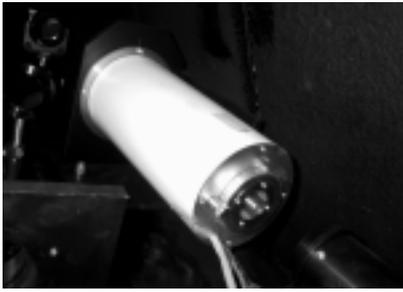
西はりま天文台太陽望遠鏡のリオフィルター（南京天文儀器廠製）。中心波長656.3nm、波長幅0.5nmの光だけを通す。
