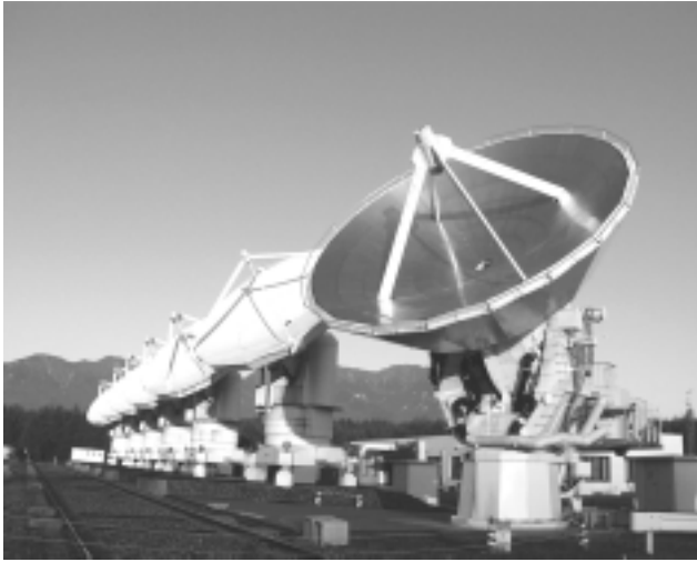
ASTE (アステ: Atacama Submillimeter Telescope Experiment) は、現在、野辺山宇宙電波観測所で試験観測を行っています。横に並ぶ白い鏡面の電波望遠鏡たちは、以前からある電波干渉計です。ミリ波の観測を目的に作られた干渉計に対して、サブミリ波をターゲットとするASTE(手前)は、アンテナが鏡のようにピカピカです。(写真提供: 国立天文台野辺山 中西康一郎氏)
