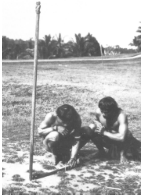
ノーモン 垂直棒の影の長さを調べる。影が最も短くなれば太陽の南中。これは毎日変化し、その1周期が1年である。
