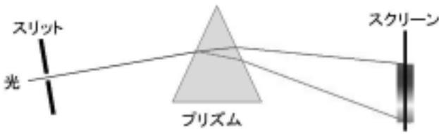
図1 プリズムによる分光の模式図。プリズムは光を「単色の色」にわけることができます。
