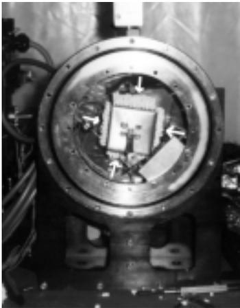
図2：CCDカメラ内部の様子。白い矢印が指しているぶつぶつしたものが吸着材。
