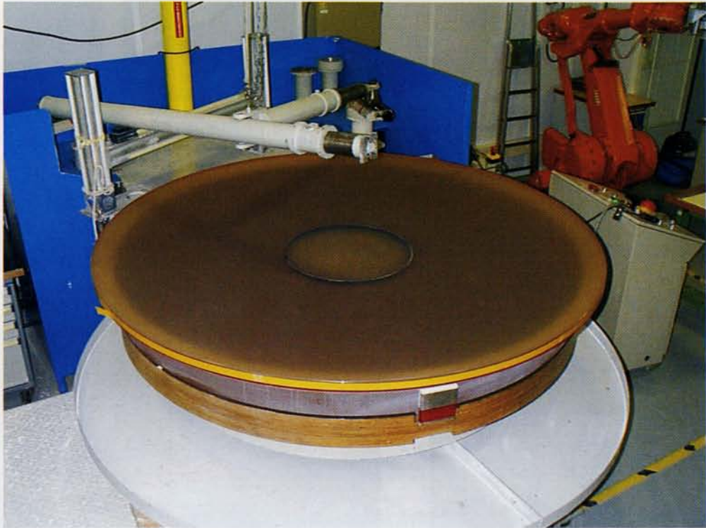
大まかな形状出しが完了した主鏡鏡材 (2003年3月)
