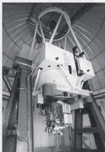
写真2: 南アフリカ天文台 1.4m 望遠鏡。近赤外線カメラが装着されている。西はりま天文台の60cm 望遠鏡に取りつけられるNICHOSも近赤外線カメラです。また、製作中の2m望遠鏡にも近赤外線カメラがそなえられます
