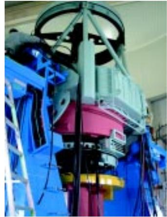
先月号の表紙写真で三菱電機尼崎工場で完成した2メートル望遠鏡をごらんいただきました。その後、分解、運搬して今では西はりま天文台2メートル観測室の中に同じような姿で設置されています。工場内での組立を仮組、現場での組立を本組といいますが、最終的には本組で機械的な精度を出さなくてはなりません。
