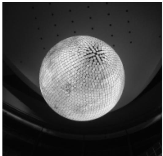
ジオ・コスモス(Geo・Cosmos) 日本科学未来館(東京都江東区/2001年7月に開館)のシンボル展示。1階から6階までの吹き抜け空間に浮かぶ、直径6.5メートルの球体ディスプレイ。球体の表面にはLEDパネルが貼り込まれ、NASAを經由して衛星から送られてくる画像データをほぼリアルタイムで取り込み、刻々と変化する地球の姿を始め火星、金星、月なども映し出すことができる。
