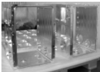
近赤外線3色カメラ NIC 用と近赤外線分光器 NIS 用に2つの真空冷却容器がつけられます
