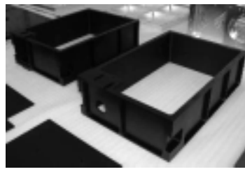
この中に検出器・光学系等が収められマイナス180 程度まで冷却されます
