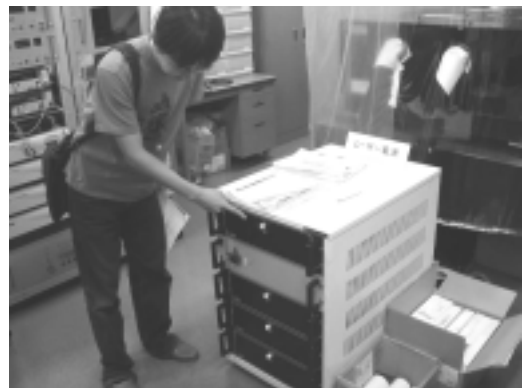
写真5：下里水路観測所のレーザー発振設備。右は電源。4つのコンデンサーに電気をためて、1秒間に4回放電しています。左がレーザー発振機。人類は、以外と簡単な設備で強力なレーザーが放射できるのです
