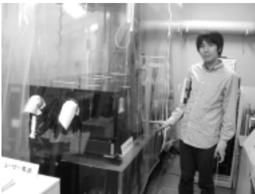
写真5：下里水路観測所のレーザー発振設備。右は電源。4つのコンデンサーに電気をためて、1秒間に4回放電しています。左がレーザー発振機。人類は、以外と簡単な設備で強力なレーザーが放射できるのです
