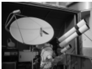
図2：太陽モニター望遠鏡。手前のパラボラアンテナでは12GHzの電波を、奥の屈折望遠鏡では白色光とH \alpha 光を観測しています。今年の1月には太陽フレアをとらえることに成功しました。こちらのリアルタイムデータもホームページなどで公開しています。
