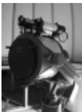
図4：K-1420式カメラ。広視野の天体写真用カメラで、17度の円形の視野を持っています。彗星や星雲のような大きく広がった天体を撮影するのに便利です。現在は使われることが少なくなりましたが、まだまだ現役のカメラです。
