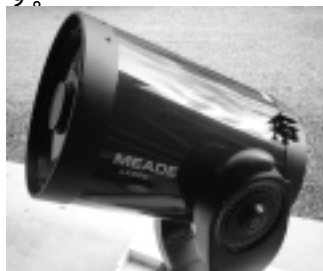
図5：ミードLX200(シュミット・カセグレン式望遠鏡)。口径20cmのカセグレン式反射望遠鏡で、鏡筒の先にシュミット補正板がついています。自動で天体導入してくれるすぐれもので、出前観望会ではお客さんの大人気です。
