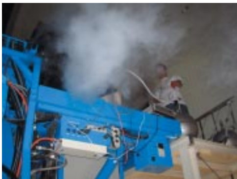
ナスミス台にのっている分光器内のCCDカメラに液体窒素を入れています
