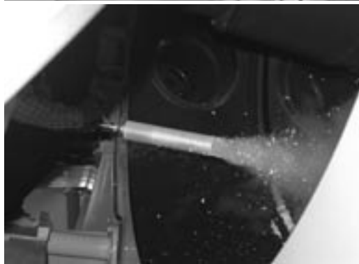
図3：鏡洗浄では細心の注意が払われる。乱暴にふいたりすると鏡面を傷つけてしまう
