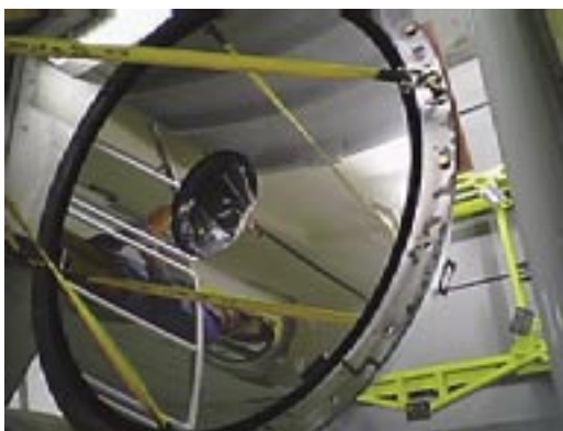
図3：主鏡セルを中3階まで慎重に降ろします
