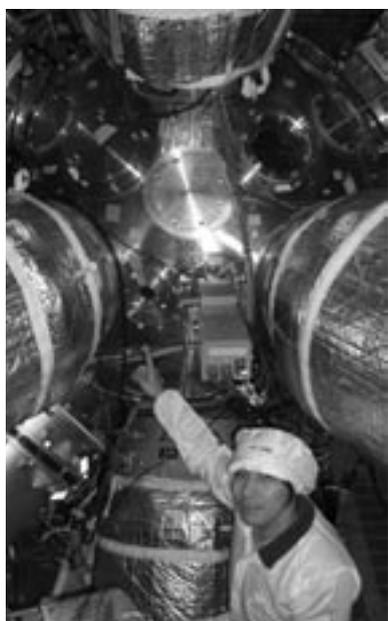
この球体の中に入ったターゲットが高エネルギーのレーザー光線が複数の方向から照射されます。言ってみれば、ボールペンの先ほどのサイズの太陽ができるのです
