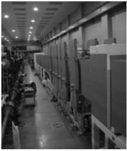
右側の装置が10ペタワットのレーザー光線が可能な「LFEX」
