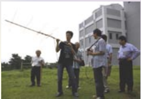
八木アンテナで衛星と通信をしている最中
