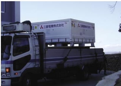
運搬箱も幅が3 m近くになる。トラックの荷台からはみ出しているのがわかる
