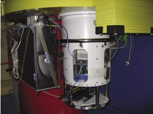
なゆたカセグレン焦点に取り付けられた東北大学の観測装置。液晶チューナブルフィルターと言う液晶の特徴を活かした狭い波長幅（7ナノメートル）で観測できるフィルターに、空気の揺らぎによるブレを止めるための高感度高速撮像カメラが取り付けられている
