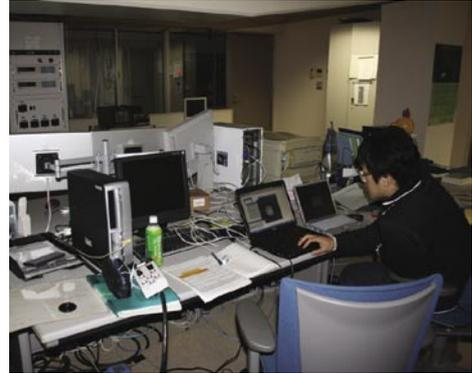
なゆた観測制御室での観測風景。高速撮像のため、カメラとパソコンを直接LANケーブルでつないでデータ転送を行った
