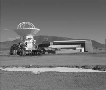
専用台車に乗せられて標高 2900m の山麓施設から 5000m の山頂施設に到着したアンテナ (ALMA/NAOJ 提供)
