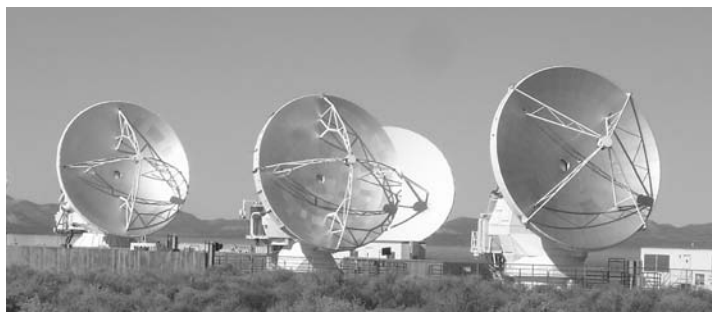
各国のプロトタイプアンテナ。左から日本、アメリカ、ヨーロッパ。「副鏡ステイ」の形がちがいます。提供：ALMA/NAOJ
