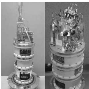
日本が開発・製作した受信機。 左「バンド4 (125～163GHz)」 右「バンド8 (385～500GHz)」 提供：ALMA(ESO/NAOJ/NRAO)
