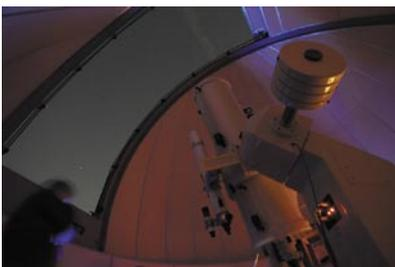
40cm ニュートン・カセグレン式反射望遠鏡
