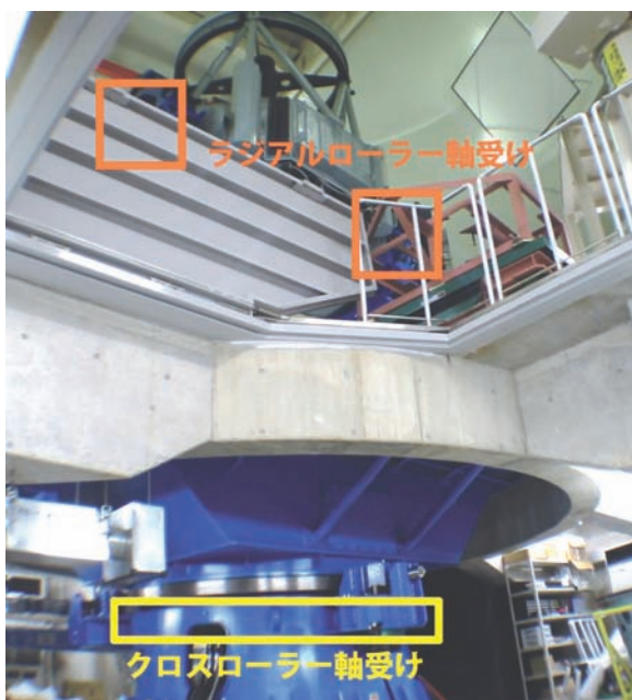
なゆた望遠鏡、60cm 望遠鏡の軸受け
