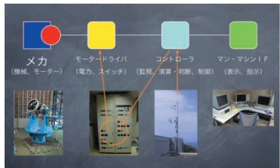
図5：なゆた望遠鏡におけるメカトロの構成要素の概略
