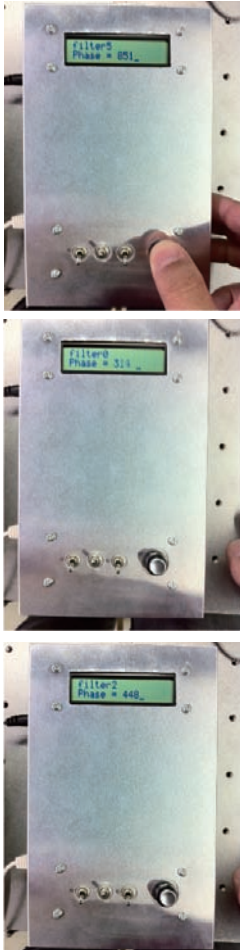
図 14：マニュアル操作 3つのトグルスイッチ (3bit) で 0~7の数値 (フィルターの番号) を指定してプッシュスイッチを押すと、コントローラがフィルターターレットを制御して「filter5 (現在位置) → filter0 (原点) → filter2 (目的位置)」へとフィルターを交換する
