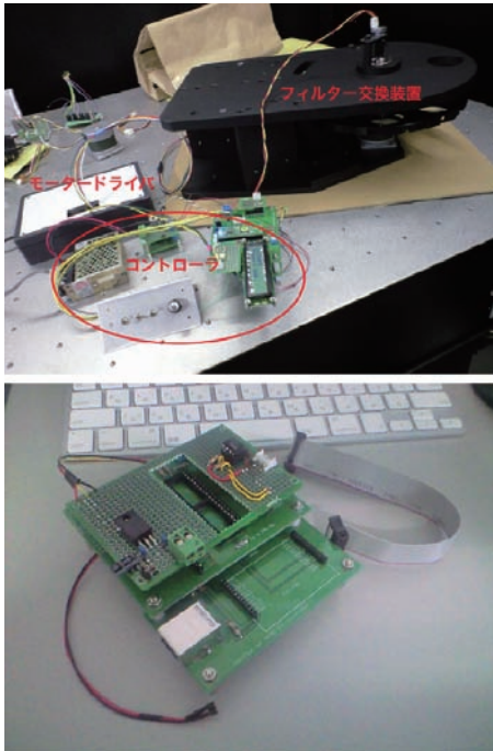
図 11：メカ実機制御試験中の機能実証機（上）と新たに組み立てたパッケージ用基板
