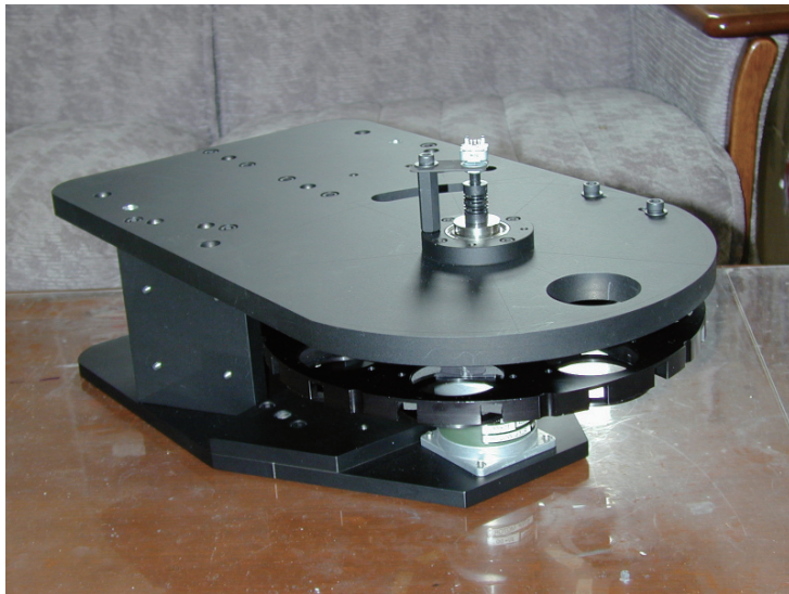
図10：VTOSの改修図（上）。赤い部分がフィルター交換機構が占められる場所。下は完成したメカ
