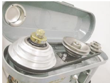
工作機械（ボール盤）に使われているベルトドライブ。ベルトをかけるプーリーを選ぶことで回転速度を変えられる
