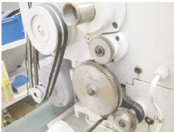
工作機械（旋盤）に使われている平歯車。歯数の違う歯車を付け替えることで回転速度を変えられる
