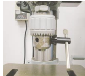
ボール盤のドリルチャックとそのハンドル。一種の傘歯車である
