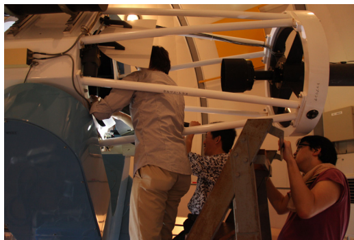
図2：60cm 反射望遠鏡の掃除の様子。
