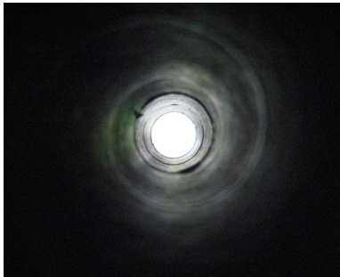
▲図5 迷光対策が十分でない望遠鏡の内部
