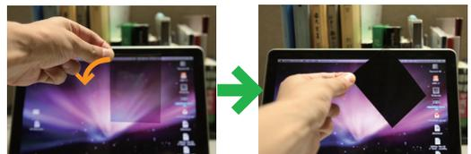
図5 偏光フィルターを回転させるとパソコンの画面が暗くなるので、偏光していることが分かる。
