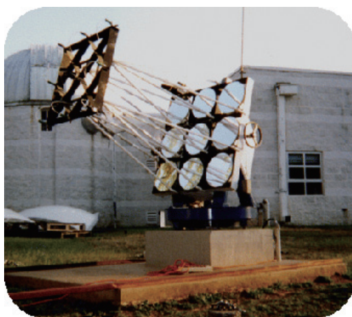
図3：Multiple Telescope Telescope の写真。9 個の望遠鏡が一つの架台に載る。それぞれの主焦点部にファイバーの入口がある。ジョージア州立大学のホームページから
