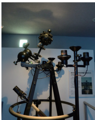
左がイエナ ZKP-1 No.165。(ZKP-1 は 1952 年から 1977 年までに 257 台製造)。右が STARMASTER ZMP No. 578
