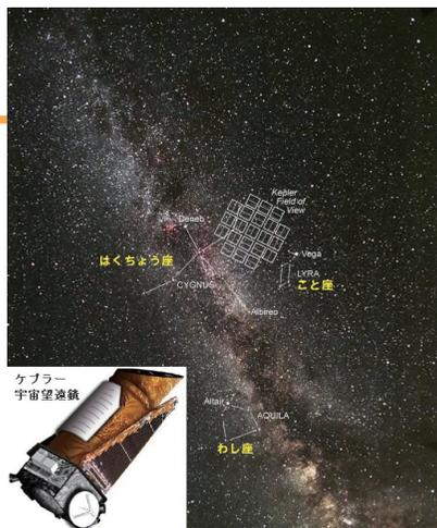
図1：ケプラー宇宙望遠鏡とケプラーフィールド。白線の長方形が CCD1 枚の視野を表す。42 枚の CCD を使うことで、105 平方度と広い視野を一度に撮影することができる。
