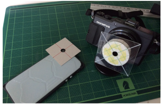
図4：コリメート撮影用の自作レンズカバー。詳しい作り方は下記 URL にある PDF ファイルを参照。 http://www.nhao.jp/~tsumu/lecture/tian_wen_jiang_yan_hui.html
