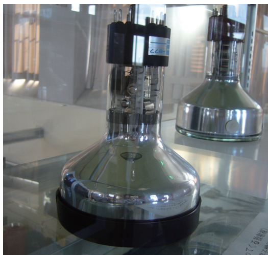
宇宙線を検出する「光電子増倍管」。兵庫県との県境に近い岡山県備前市三石にあった大阪市立大学の観測所で使われていたものです。西はりま天文台の北館2階に展示されています。
