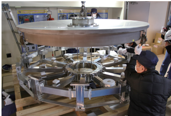
図4：専用の治具に収められようとしている主鏡。鏡側面の赤茶色が、ゼロデュアという種類のガラスの本来の色です。
