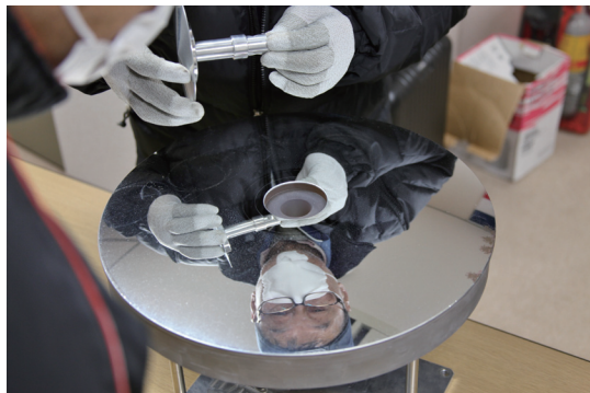
図2：およそ13年ぶりに取り外された副鏡。常に下を向いている鏡とはいえ、白く汚れています。
