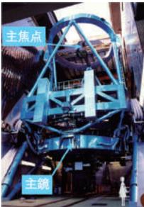
図1：すばる望遠鏡と主焦点の位置（画像提供：国立天文台）
