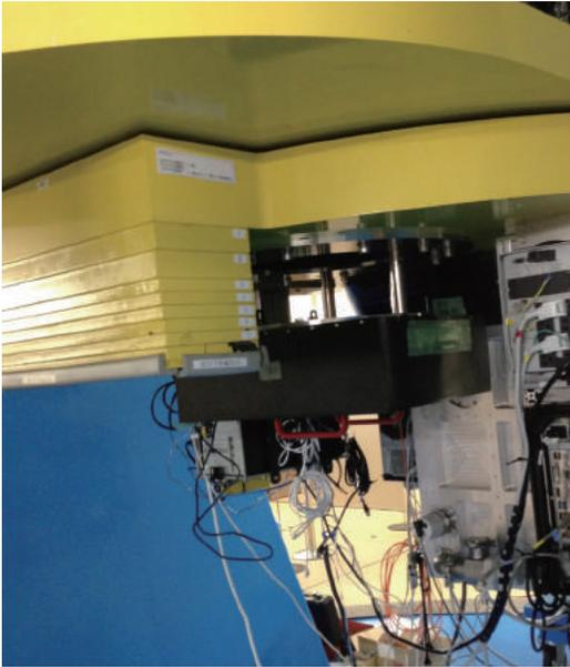
図1：なゆた望遠鏡に取り付けられた補償光学装置（手前の黒い箱）
