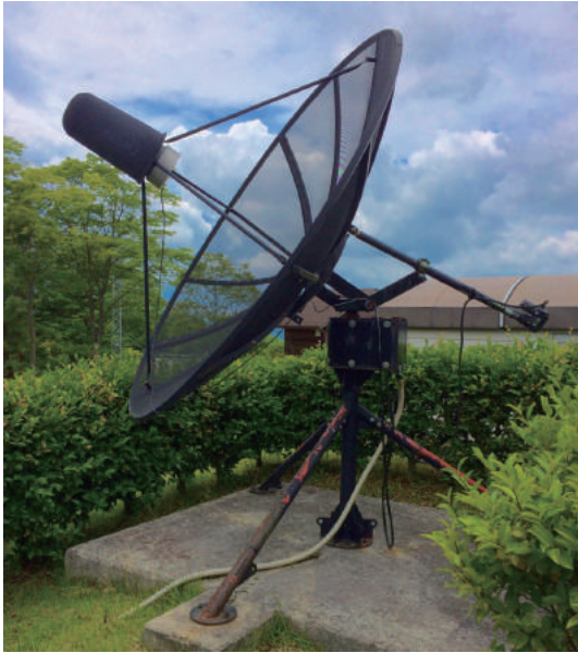
図2：西はりまの21 cm 電波望遠鏡。この電波望遠鏡は銀河の回転曲線の観測をすることができます。
